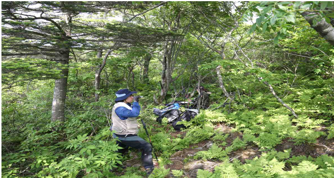
그림 7. Suunto Clinometer를 사용하여 경사를 측정하는 모습(함백산)
